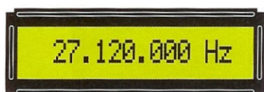
Fig.18 Poichè la frequenza Overtone di un quarzo da 27.120.000 Hz in 3° armonica è esattamente questo valore, digitate sulla tastiera il numero 27.120.000.
