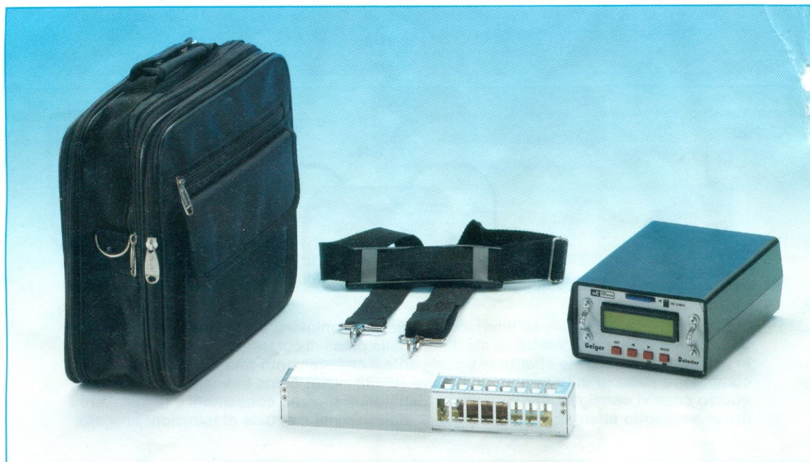
Fig.13 In questa foto sono riprodotti il contatore Geiger LX.1710 presentato nella rivista N.235, il probe in alluminio che racchiude il circuito stampato sul quale è montato il tubo Geiger LND 712 e la pratica valigetta in cordura di colore nero (codice MK60) utile per custodire e trasportare lo strumento e che potrete richiedere a parte.
