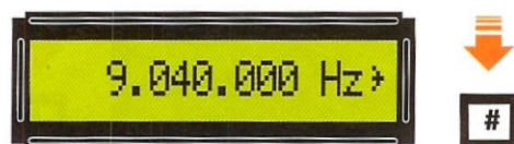
Fig.14 Dopo aver impostato il numero 9.040.000, premete il tasto # e subito vedrete apparire sulla destra di Hz il simbolo > che conferma >.
