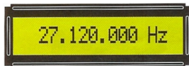
Fig.28 Poiché la frequenza Overtone di un quarzo da 27.120.000 Hz in 3° armonica è esattamente il valore riportato sul suo corpo, digitate il numero 27.120.000.
