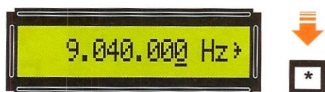
Fig.15 Ora premete il tasto * e così facendo verrà sottolineato il primo 0 a destra ad indicare che, premendo il tasto +, si modificherà la sola unità degli Hz.
