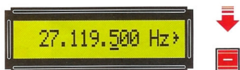
Fig.32 Premendo il tasto - quando raggiungerete il numero 27.119.500, il Tester vi indicherà un valore di tensione di circa 1,2 Volt (vedi Tabella N.2).
