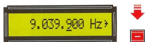
Fig.27 Raggiunto il numero 9.044.000, per ottenere una maggiore precisione dovete variare le centinaia di Hz, infatti l'esatta sintonia si ottiene sui 9.039.900 Hz.
