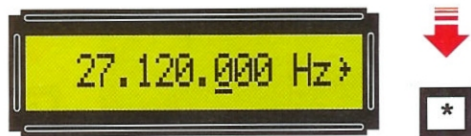
Fig.31 Poiché dovete variare le centinaia di Hz, premete il tasto * fino a sottolineare il terzo 0 e poi il tasto con il segno - per scendere in frequenza (vedi figura successiva).
