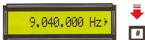
Fig.24 Digitato il numero 9.040.000, premete il tasto # e vedrete apparire sulla destra di Hz il simbolo > che segnala che dal BNC esce questa frequenza.
