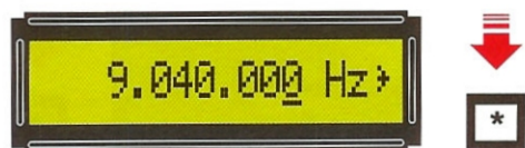
Fig.25 Ora premete il tasto * e così facendo verrà sottolineato il primo 0 a destra ad indicare che, premendo il tasto +, si modificherà la sola unità degli Hz.
